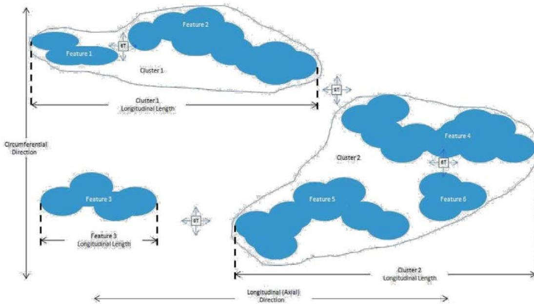
**Figure d'Enbridge : Zones d'interaction de la corrosion (2013)**
